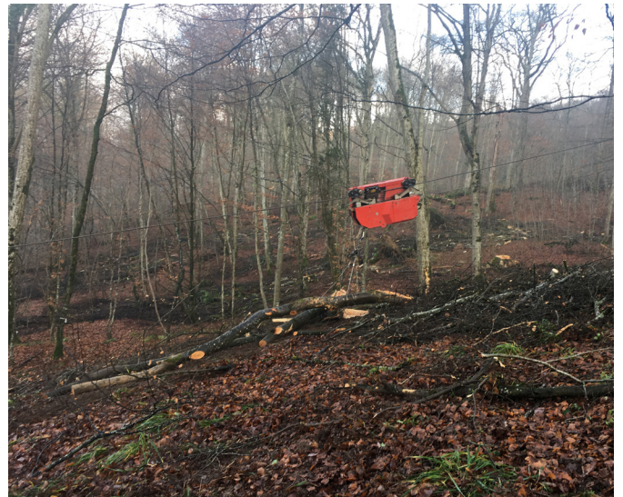
Am Trageseil befestigter Laufwagen zur Holzbringung.
